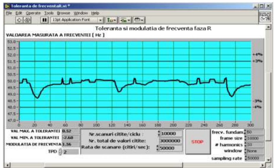
Fig.6 Toleranța și modulația de frecvență faza R
